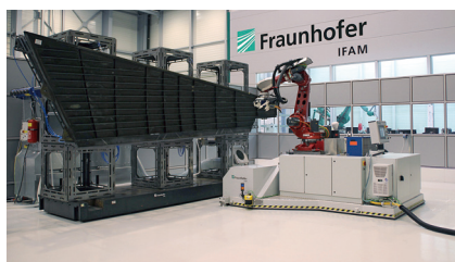
图1 移动机器人系统加工A320飞机复合材料垂尾翼面
