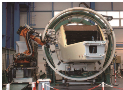
图2 某型直升机自动化装配系统
